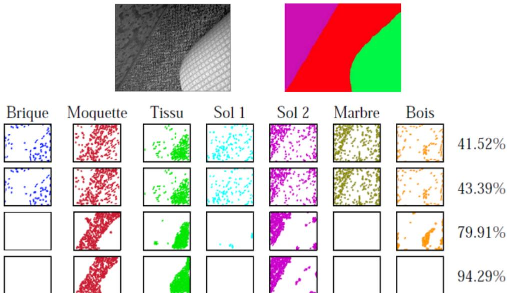
**Fig. 4.** Segmentation d'une image multi-texture : de haut en bas,  $\Sigma^{diag}$ ,  $\Sigma^{hdim}$ ,  $\Sigma^{diag}$  + champ de Markov caché et  $\Sigma^{hdim}$  + champ de Markov caché.
