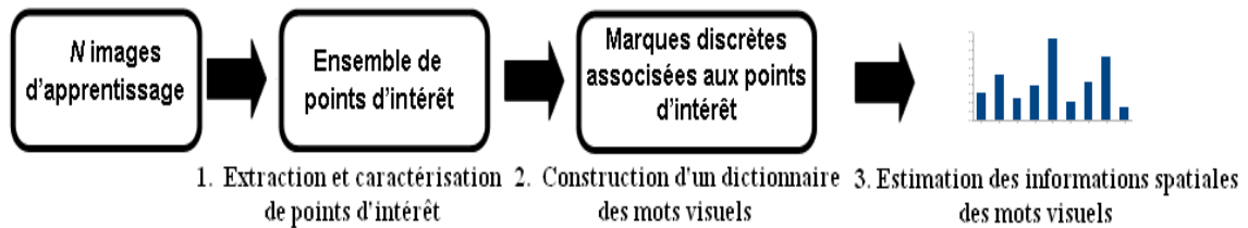
Figure 2.2 — Le schéma des étapes principales des méthodes basées sur l'analyse des informations spatiales de mots visuels.
