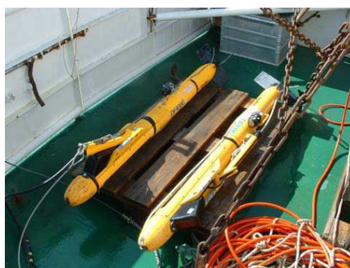
Figure 5.4 — Poisson sonar latéral tracté en position de balayage au-dessus du fond (Rebent-IFREMER).
